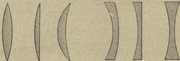
Fig. 4.—Esquema del corte de algunas formas de lentes que se emplean para fabricar objetivos fotográficos. Los tres primeros son convergentes, y los tres últimos divergentes
