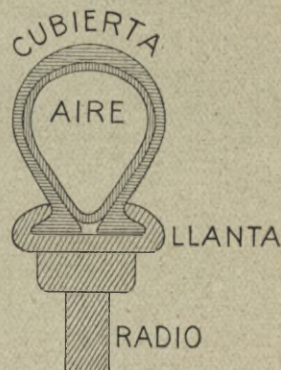
Esquema núm. 52. — Corte transversal de un neumático montado en su llanta
