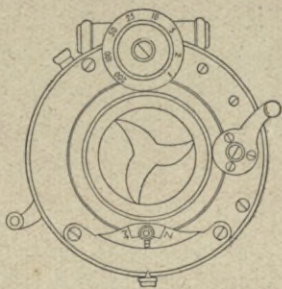
Fig. 19. — El obturador dotado de «mecanismo central», se compone de varias piezas colocadas entre las lentes
