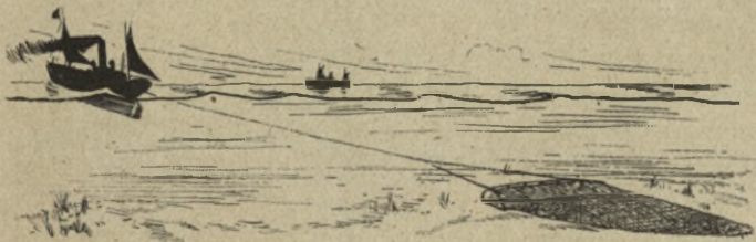
Esquema mostrando la disposición de un vaporcito pescando con redes de arrastre
