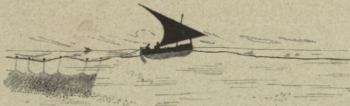
Esquema de una barca pescando con redes verticales, caladas a escasa profundidad y remolcadas lentamente
