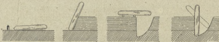
Procedimiento primitivo para transportar y elevar grandes bloques de piedra
