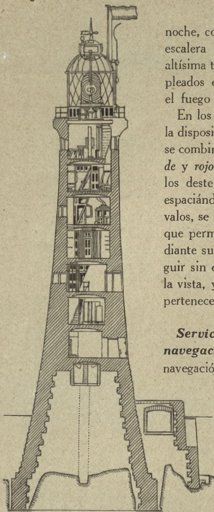
Corte esquemático de una torre de faro
