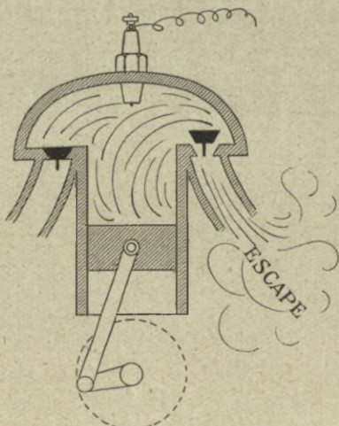
Esquema núm. 11.—Después del empuje violento de la explosión, el pistón vuelve a subir y arroja fuera los gases quemados. La válvula de escape está abierta, la de admisión, cerrada (Escape)
