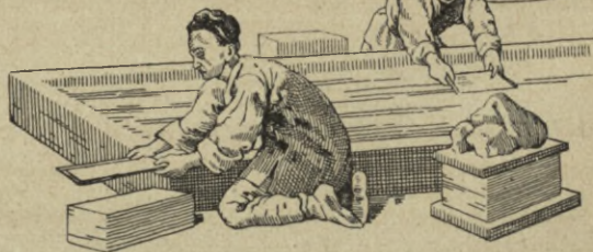
Obreros chinos moliendo la pasta con un mazo movido con el pie. Otros filtran la pasta en finos tamices. A la derecha, el montón de hojas de papel prensadas con piedras
