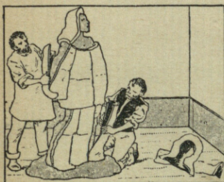
83. Cuando ya está modelada la estatua con arcilla plástica, se saca de ella un molde en yeso, dividido en varias piezas.
