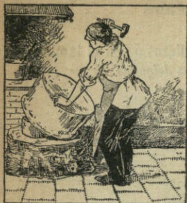
Cobre. — 18. El calderero emplea un martillo para dar forma á los objetos de cobre.
