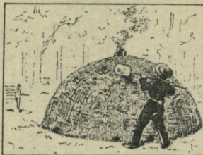
25. Carbonero amontonan-do leña para fabricar carbón ; se deja una galería horizontal que comunica con una chime-nea, y el montón se cubre con tierra húmeda.
