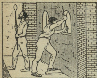
90. Un obrero saca vidrio fundido del crisol que hay en el horno, valiéndose de un tubo largo y estrecho de hierro.
