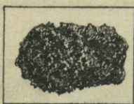
28. El cock se obtiene de la hulla (pág. 81, fig. 33) Es un carbón poroso* , de aspecto metáli-co , que arde sin lla-ma ni humo .
