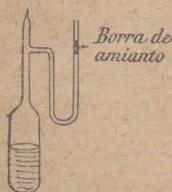
Fig. 12. — Redomas para conservar los líquidos al contacto del aire privado de gérmenes.
