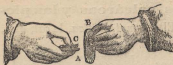
Fig. 99. — Yesquero de sílice y yesca. El choque del sílex A, contra el acero B, desprende un fragmento de acero y lo hace enrojecer bajo forma de una chispa que enciende la yesca C.
