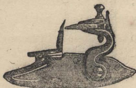
Fig. 100. — Gatillo de fusil de piedra. Es la chispa la que enciende la pólvora.
