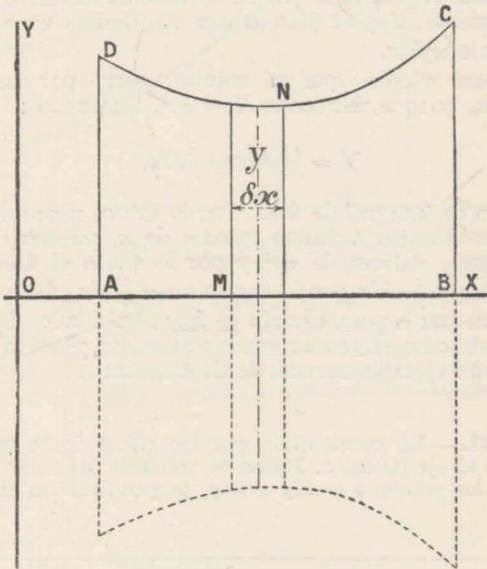
Fig. 44. — Volumen de un sólido de revolución
