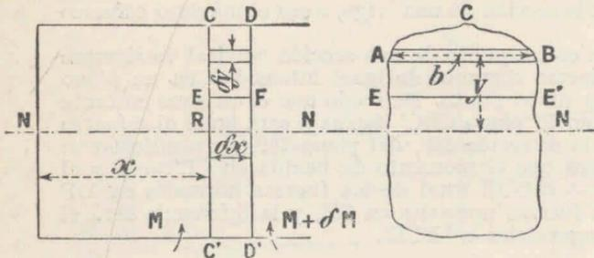
Fig. 113. — Esfuerzos cortantes en las vigas
