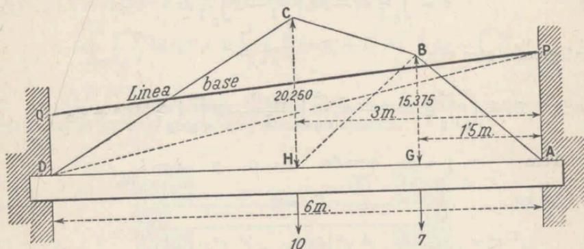
Fig. 112. — Momentos flectores y de empotramiento de una viga cargada
