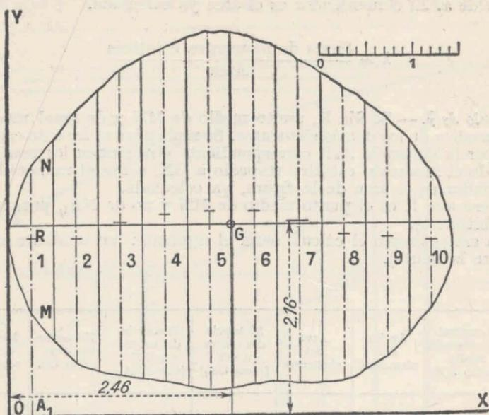
Fig. 62. — C. d. g. de una plancha delgada
