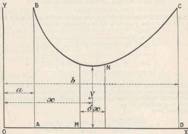
Fig. 70. — C. d. g. de un sólido de revolución
