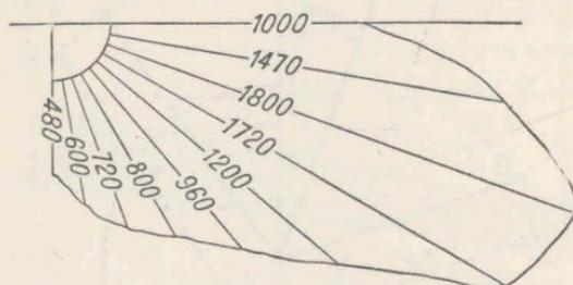
Fig. 93. — Potencia de una lámpara de arco
