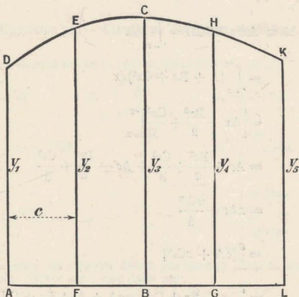
Fig. 35. — Demostración de la regla de Simpson
