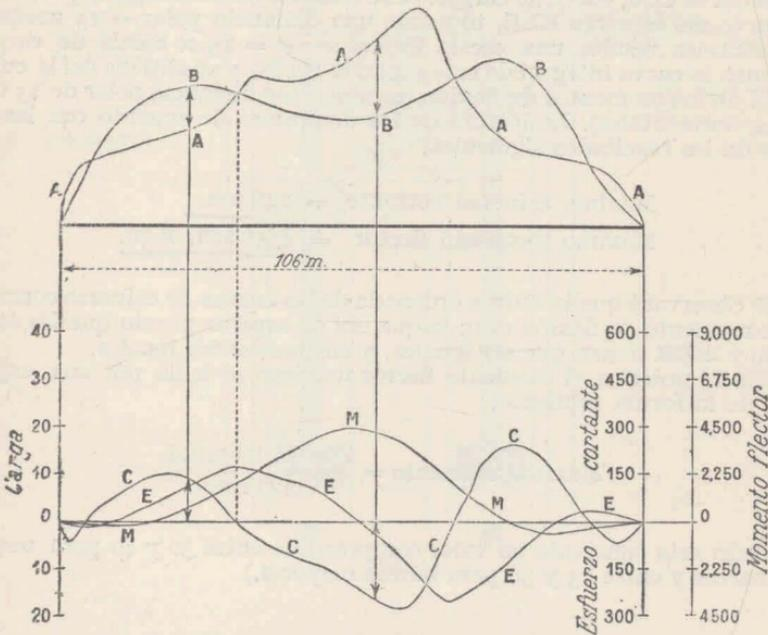
Fig. 32 — Esfuerzo cortante y momento flector para el casco de un barco
