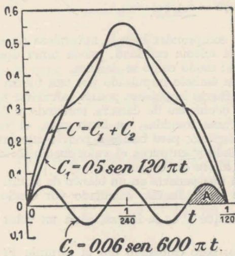
Fig. 40. — Problema sobre una corriente alterna
