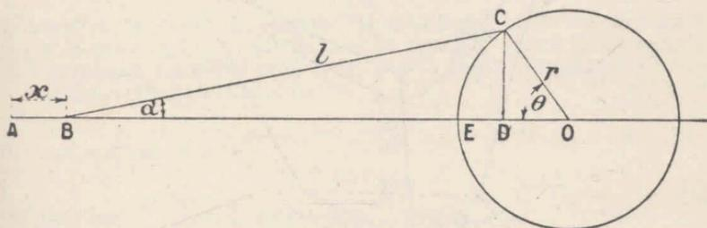
Fig. 16. — Velocidad y aceleración de un émbolo.
