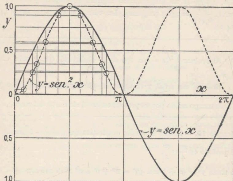
Fig. 42. — Media cuadrática de una corriente alterna
