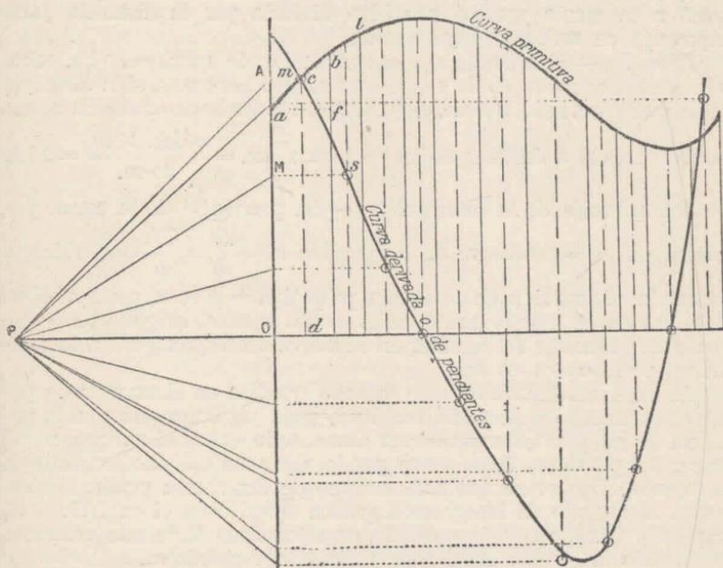
Fig. 2. — Derivación gráfica, método 1.º
