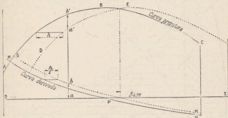
Fig. 3. — Derivación gráfica, método 2.º
