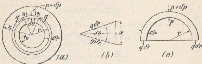
Fig. 120. — Esfuerzos en cilindros de paredes gruesas
