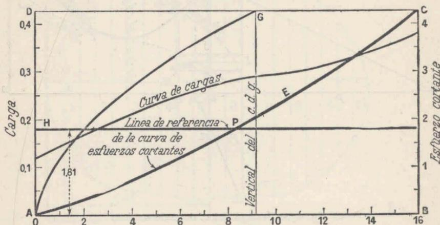
Fig. 64. — Problema sobre una viga cargada
