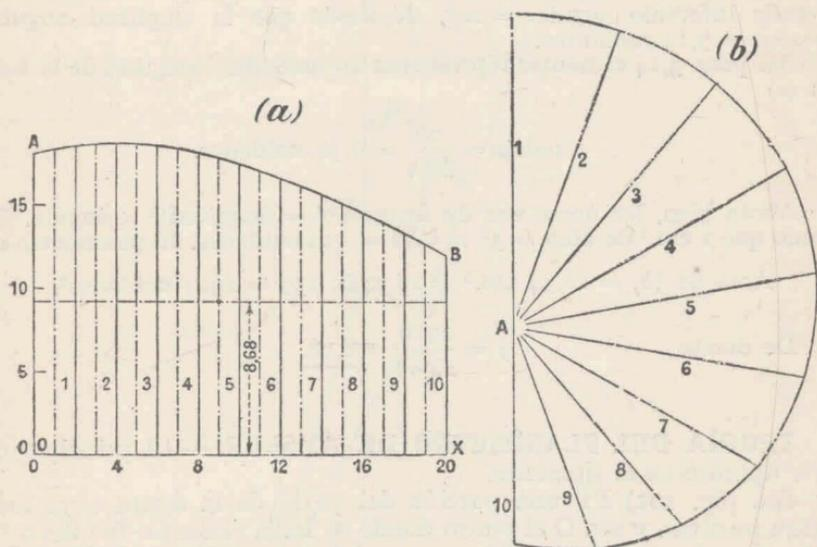
Fig. 100 — Determinación de un c. d. g. mediante un diagrama polar
