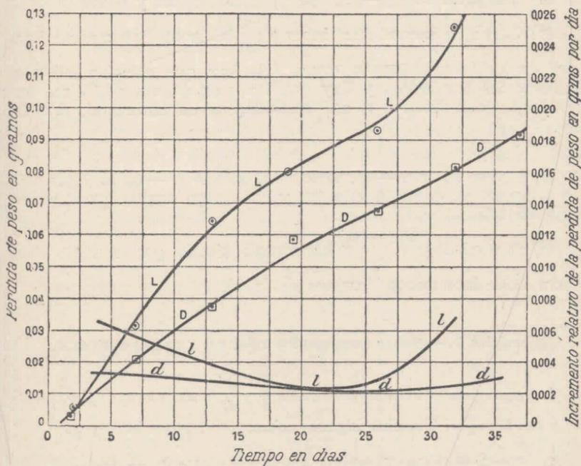
Fig. 6. — Ensayos sobre corrosión de placas de hierro
