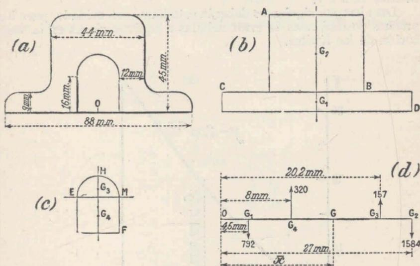
Fig. 66. — Centro de gravedad de la sección de un carril Brunell hueco
