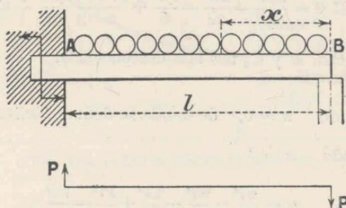
Fig. 109. — Viga uniformemente cargada
