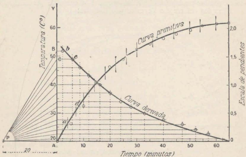
Fig. 3a. — Variación de la temperatura del devanado de un motor
