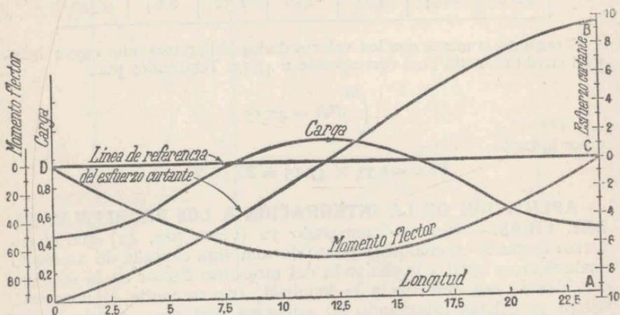
Fig. 31. — Problema sobre una viga cargada
