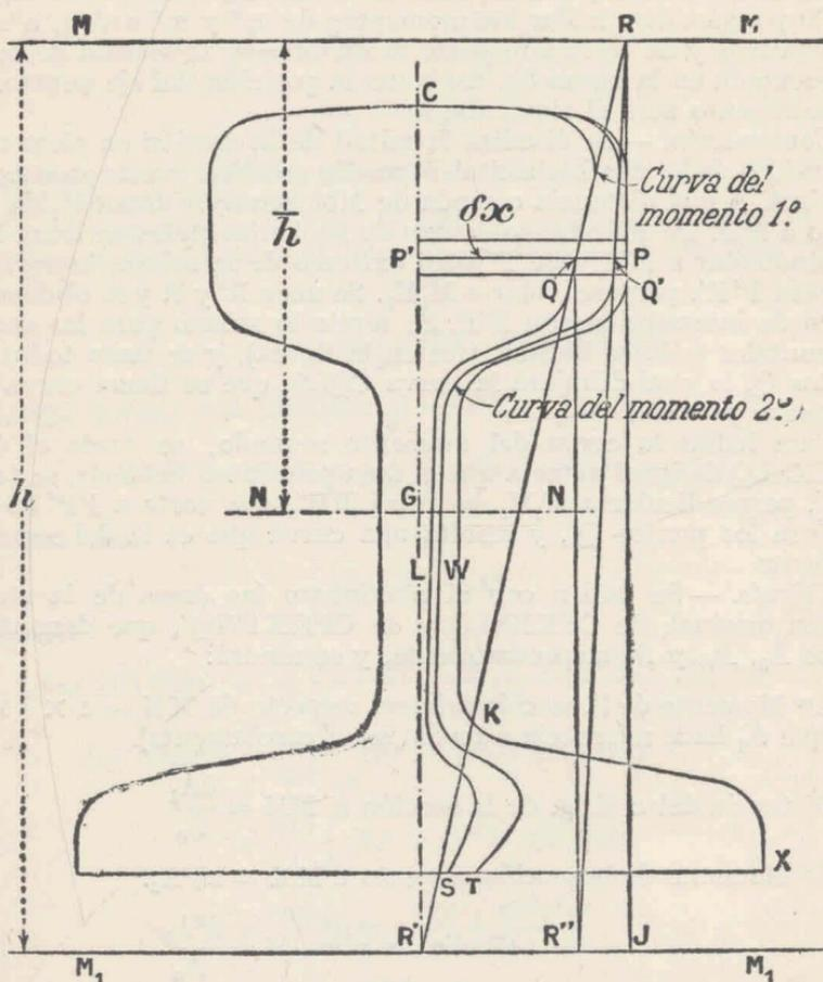
Fig. 89. — Momentos de secciones obtenidos por medio de construcciones gráficas
