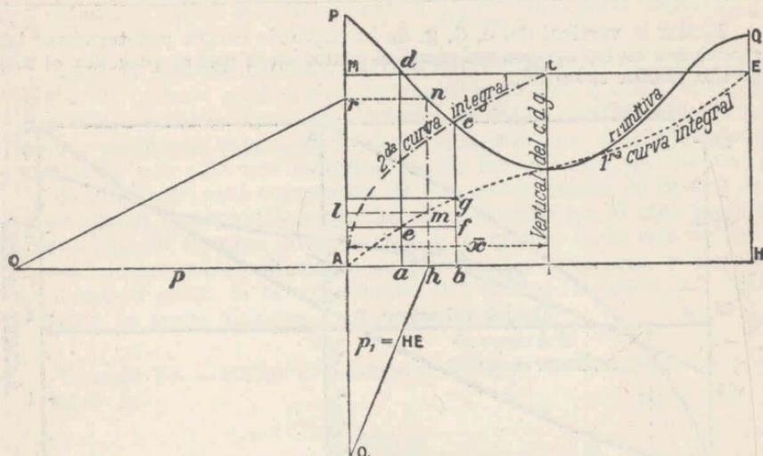
Fig. 63.—Vertical del c. d. g. de un área
