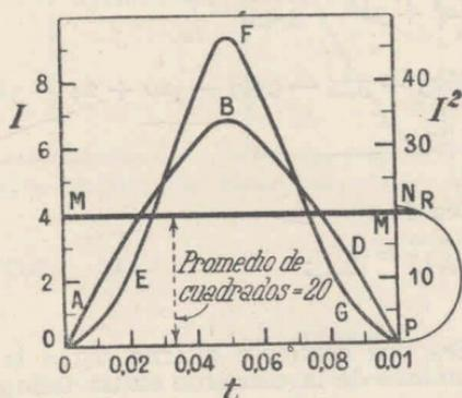
Fig. 41. — Media cuadrática de una corriente alterna
