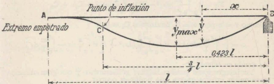
Fig. 110. — Curva elástica de una viga
