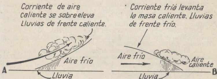
Fig. 49. — Frente caliente, fig. A. El aire caliente se eleva trepando sobre el frío. Su humedad se condensa y llueve. Frente frío, fig. B. La corriente fría impele hacia arriba al aire caliente. Su humedad se condensa y llueve.
