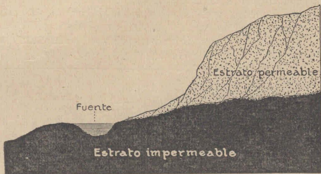
Fig. 56—Otro corte que permite apreciar los efectos de la impermeabilidad
