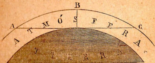
FIG. 3. — Diagrama que representa la influencia ejercida sobre los rayos del Sol por el espesor variable de la atmósfera. A. Línea de los rayos solares por la mañana. B. Línea de los rayos al medio día. C. Línea de los rayos al ponerse el Sol.
