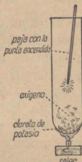
Fig. 22.—Preparación del oxígeno calentando clorato de potasio.
