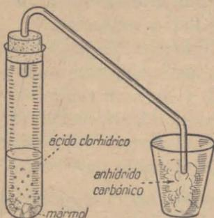
Fig. 26.—Obtención del anhídrido carbónico con trocitos de mármol y ácido clorhídrico.
