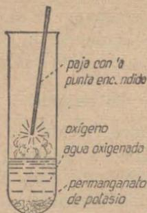
Fig. 23.—Obtención del oxígeno con permanganato de potasio y agua oxigenada.
