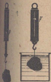
Fig. 275.—Determinación de densidades con dinamómetro.
