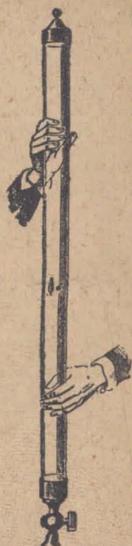
Fig. 138.— Haciendo vacío en el tubo de Newton, se comprueba que varios cuerpos pequeños, de peso muy diferente, caen con igual aceleración.
