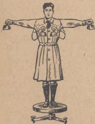
Fig. 225.—Al abrir los brazos, disminuye la velocidad angular porque aumenta el momento de inercia. Se conserva el impulso.
