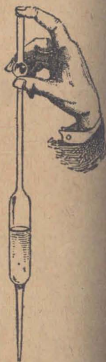
Fig. 321.—Pipeto para líquidos. La presión atmosférica impide el derrame.
