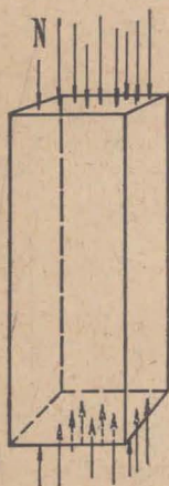
Fig. 376.—Prisma sometido a compresión.
