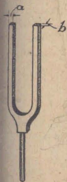
Fig. 390.— La frecuencia del sonido dado por el diapasón depende del ancho a , pero no del espesor b .
