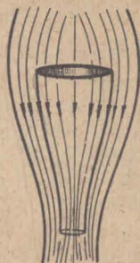
Fig. 298. — Movimiento laminar; líneas y tubo de corriente.
