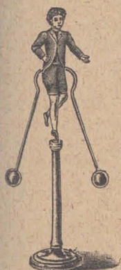
Fig. 107.—Equilibrio estable. El centro de gravedad está fuera del cuerpo.
