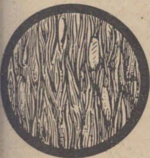
Fig. 28. — Sección microscópica de una roca arcillosa en la que se ha desarrollado la estructura hojosa.
