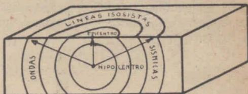
Fig. 150. — Propagación de las ondas sísmicas, según Mallet.
