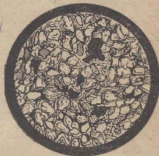
Fig. 27. — Sección microscópica de una roca arcillosa no modificada.
