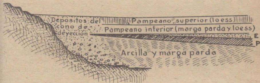
Fig. 217. — Corte esquemático para mostrar las vinculaciones existentes entre los depósitos del pie de las montañas y los sedimentos terciarios y cuaternarios de la llanura pampeana, según Windhausen.
