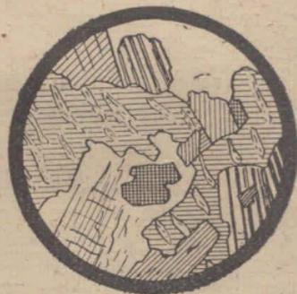
Fig. 11. — Sección microscópica del mismo granito de la fig. 10 vista con luz polarizada.
