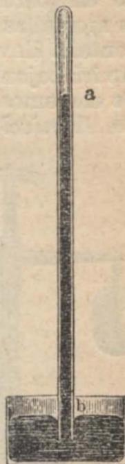
Fig. 38. — Barómetro de Torricelli: a, b, columna de mercurio.
