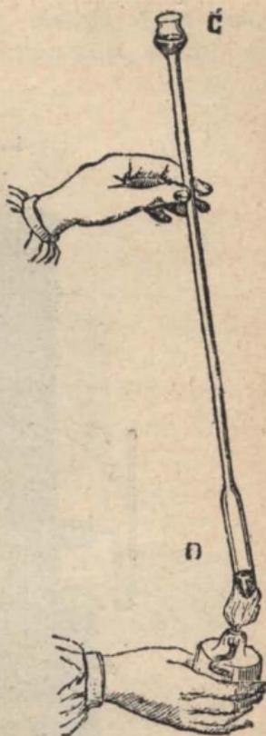
Fig. 48. — Preparación del tubo para el termómetro. En *C* se pone el mercurio; en *D* se aplica una lamparilla; el aire, por la acción del calor, sale del tubo, y entonces cae en *D* el mercurio que se puso en *C*; se corta el embudo *C* y se deja soldada la extremidad superior; la inferior también va cerrada.
