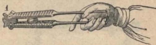
Fig. 14. — Palanca de segundo género: 1, punto de apoyo.
