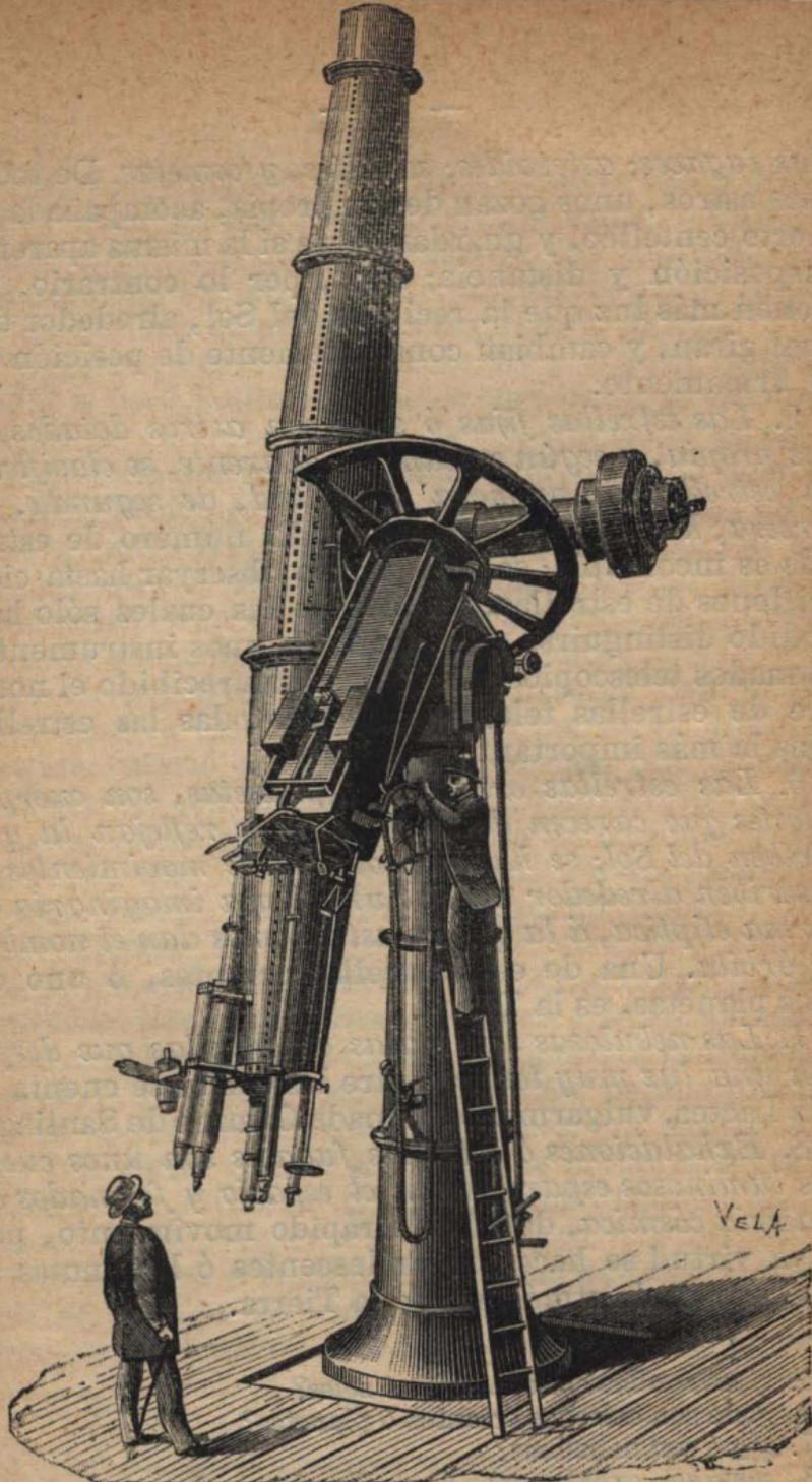
Fig. 1.<sup>a</sup>—Telescopio.—En el telescopio, la imagen del astro observado se refleja en un espejo metálico que tiene el instrumento en su interior; y el astro se ve como si estuviera quinientas ó mil veces más próximo de lo que está realmente.
