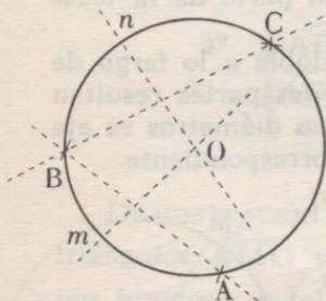
**DEMOSTRACIÓN.** Los puntos A, B y C, no alineados, pueden considerarse vértices de un triángulo y por un teorema ya estudiado las mediatrices de sus lados se cortan en un punto O que equidista de sus vértices A, B y C.
