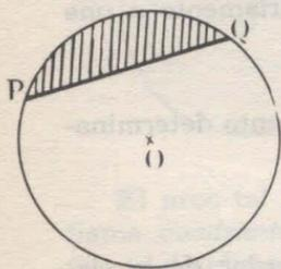
**16. Segmento de círculo.** — Si en una circunferencia se traza una cuerda, ésta queda dividida en dos partes, cada una de las cuales se llama *segmento de círculo*.
