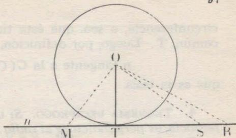
3. **Rectas tangentes a una circunferencia.** — Si en una circunferencia se traza un radio, el  $\overline{OT}$ , por ejemplo, y por este punto de contacto  $T$  se traza la recta  $n$  perpendicular al radio, se observa que esta recta  $n$  resulta tangente a la circunferencia.
