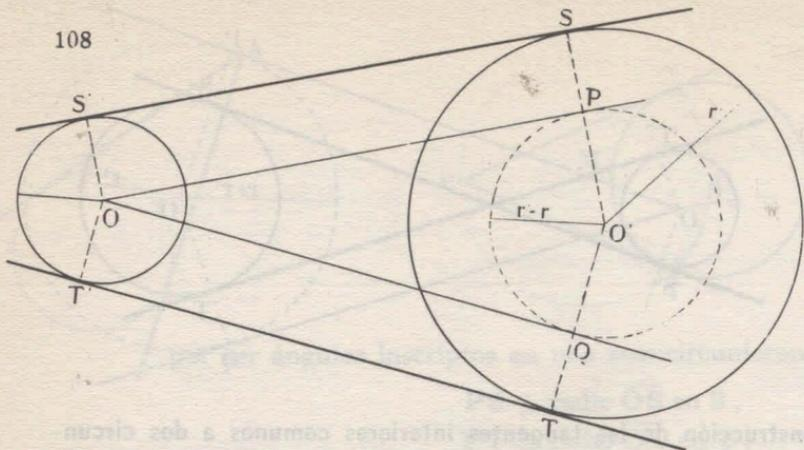
Por  $O$ , y en el semiplano respecto de  $OP$ , que contiene a  $S$  se traza una paralela a  $O'S$  que determina con la  $C(O; r)$  el punto  $S'$ . Las rectas  $SS'$  y  $TT'$ , son las tangentes buscadas.
