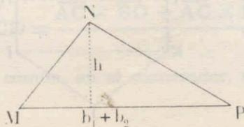
y como la superficie de un triángulo es igual al semiproducto de las bases por la altura es:
