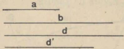
CONSTRUCCIÓN. — Tomamos una recta y sobre ella un punto  $A$ , Fig. 70, a partir del cual construimos  $AB = a$ . A la derecha de  $B$  construimos  $BC = b$ . Con una abertura del compás igual a  $d$  y con centro en  $A$  trazamos el arco  $n$ .
