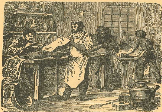
Fig. 73. — Moldagem de massa de porcellana sobre fôrmas de gesso
