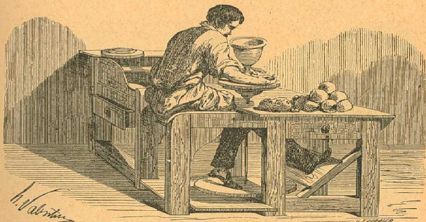
Fig. 77. — Operario louceiro, modelando uma peça ao torno
