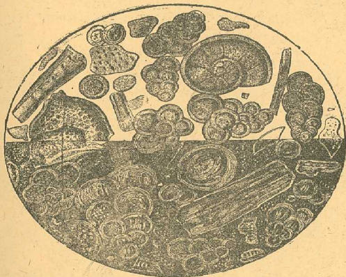
Fig. 63. — Fragmento de giz visto com o microscopio (uma metade foi ligeiramente atacada por um acido)
