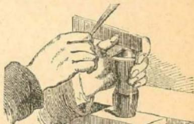
LA TALLA DE LOS DIAMANTES. — I. Obrero frotando un diamante contra otro para pulirlo. — II. Obrero tallando un diamante por medio de un cuchillo de acero sobre el cual da un golpe seco. Así produce facetas dispuestas con arte para despedir la luz y dar brillo á la piedra preciosa.
