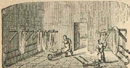
secadero de vapor. Pieza calentada por tubos de calorifero y en la cual se tienden los algodones que se quiere secar.
