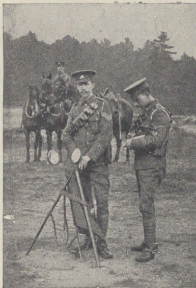
El heliógrafo es una especie de telegrafía natural, por medio de la cual los mensajes se expiden reflejando convencionalmente los rayos de sol en un espejito. Emplease en este sistema el alfabeto Morse: la mayor o menor duración de los rayos reflejados representan respectivamente las líneas y los puntos.
