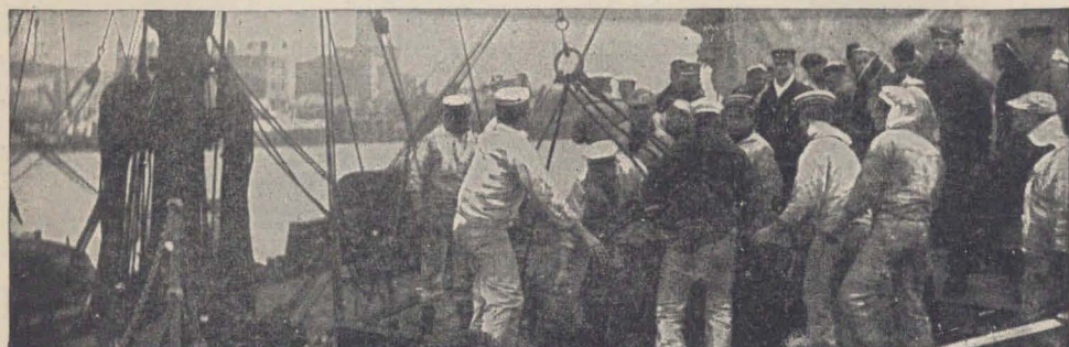
El carbón es elevado en sacos por medio de grúas desde los muelles o desde barcazas que se acercan al barco.
