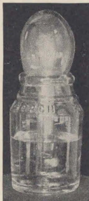
2. Barómetro hecho con un tarro de cristal y una ampolla de cuello largo.
