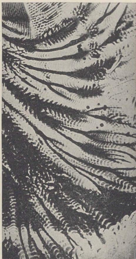
Para obtener el dibujo de la izquierda, se cubrió de pintura un cristal plano y se puso sobre la copa, con la pintura descansando en la cubierta de caucho, y cuando cantaron en el tubo se hizo girar el cristal y apareció este caprichoso dibujo. El dibujo de la derecha se obtuvo cantando alto y teniendo pintura húmeda en el cristal.
