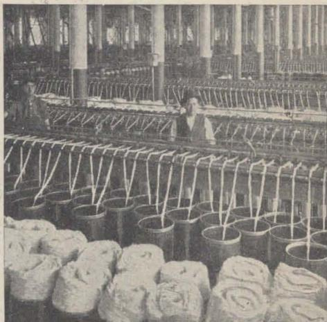
A esta operación sigue el estirado y doblado, con torsión de la cinta que se ha obtenido en las operaciones anteriores. Las hebras de algodón salen de los cilindros en que están arrolladas, pasan por los rodillos que ejecutan el estirado y se devanan en bobinas.
