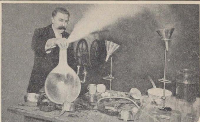
A la izquierda vemos un calderillo que contiene aire líquido, colocado encima de un trozo de hielo, y que parece estar lleno de agua hirviendo. Como la temperatura del hielo es muy alta comparada con la del aire líquido, éste se convierte en un gas igual al aire atmosférico. El segundo grabado representa una copa llena de aire líquido que ha sido sumergida en una botella de agua, escapándose el aire por la boca de la botella con fuerte silbido, como el del vapor.
