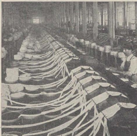
Luego se reúnen varias cintas, las cuales pasan por otra máquina llamada manuar o banco de estiraje, que ejecuta la operación del estirado, gracias a la cual, las cintas adquieren un grueso uniforme, resultando, además, paralelas todas las fibras.
