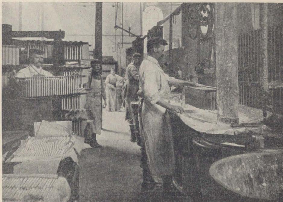
Según el antiguo procedimiento, el pábilo o mecha se sumergía repetidas veces en la grasa o sebo en fusión hasta adquirir el grueso deseado. Una sola torcida servía para dos bujías que se dejaban secar colgándolas. Esta fabricación era defectuosa, pues obligaba al uso de despabiladores.
