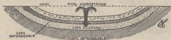
Fig. 331.—Esquema de un pozo artesiano.
