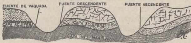
Fig. 328.—Esquema de los principales tipos de fuentes.
