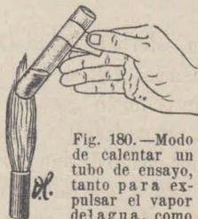
Fig. 180.—Modo de calentar un tubo de ensayo, tanto para expulsar el vapor de agua, como para hervir un líquido.
