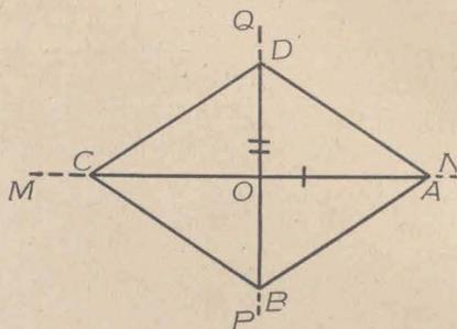
SOLUCIÓN. — Se trazan dos rectas perpendiculares en O y se lleva sobre una de ellas los segmentos  $\overline{OA} = \overline{OC}$  igual a la mitad de la diagonal  $d$  y sobre la otra los  $\overline{OB} = \overline{OD}$  igual a la mitad de la otra diagonal  $d'$ . Uniendo A con B y D y C con B y D se tiene el rombo pedido.
