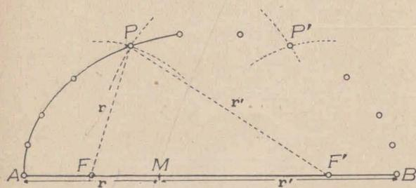
punto  $M$  cualquiera de  $\overline{FF'}$  y con centro  $F$  y radio  $\overline{AM}$  trazamos un arco de circunferencia al que cortamos con otro de centro  $F'$  y radio  $\overline{BM}$  obteniendo el punto  $P$  de la elipse, puesto que  $\overline{FP} + \overline{PF'} = \overline{AM} + \overline{MB} = \overline{AB}$ .
