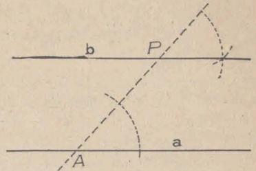
CUARTO MÉTODO. — Con centro P se traza una circunferencia que corte a *b* en el punto M'. Con centro en M' y con el mismo radio se traza otra circunferencia que pasa por P y que corta a *b* en el punto M. Con centro en M' y con radio  $\overline{MP}$  se traza una circunferencia que corta a la primera en los puntos P' y P'' (P'' no está en la figura). La recta *b'* determinada por P y P' es paralela a la recta *b*.
