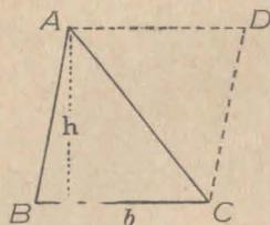
y por lo tanto la superficie del triángulo ABC será la mitad de la del paralelogramo que era  $\text{base} \times \text{altura}$ , o sea
