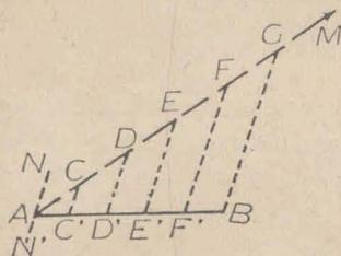
Se traza una semirrecta AM y se llevan a partir de A cinco segmentos consecutivos iguales,  $\overline{AC} = \overline{CD} = \overline{DE} = \overline{EF} = \overline{FG}$ , se une G con B y se trazan paralelas a GB por C, D, E y F, que cortan a AB en C', D', E' y F', respectivamente, dividiendo al segmento AB en cinco partes iguales.
