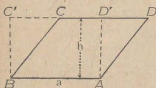
formado el rectángulo ABC'D' que tiene la misma superficie que el rectángulo dado, pues son sumas del trapecio ABCD' y de los triángulos iguales BCC' y ADD'. Y como la superficie del rectángulo es igual a la base por la altura, y éstas son las mismas que las del paralelogramo dado, se tiene
