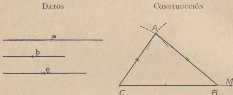
SOLUCIÓN. — Se construye un segmento  $BC = a$ . Con centro C y radio igual a  $b$  se traza una circunferencia y con centro B y radio igual a  $c$  otra circunferencia que corta a la anterior en dos puntos A y A' (A' no está en la figura). Uniendo A con B y C se obtiene el triángulo ABC pedido.
