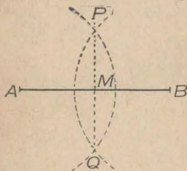
Trazando la circunferencia de centro A y radio mayor que la mitad de  $\overline{AB}$  y con el mismo radio la de centro B, ésta corta a la anterior en dos puntos P y Q. Uniendo P con Q resulta que  $\overline{PQ}$  corta a  $\overline{AB}$  en un punto M que lo divide en dos partes iguales.
