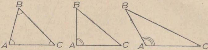
**Suma de los ángulos de un triángulo.** — *La suma de los ángulos de un triángulo es igual a dos ángulos rectos.*
