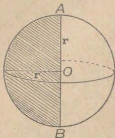
EJEMPLO: El semicírculo de centro O y de radio  $\overline{OA} = r$  engendra la esfera de centro O y radio  $r$ .
