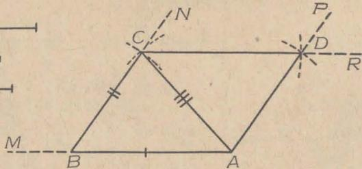
SOLUCIÓN. — Como los dos lados consecutivos y la diagonal forman un triángulo se empieza por construirlo, para lo cual se procede como en el problema III de la página 28 y se trazan el triángulo ABC. Con centros en A y en C y radios  $b$  y  $a$ , respectivamente, se trazan arcos que se cortan en D. Uniendo D con C y con A se obtiene el paralelogramo pedido.
