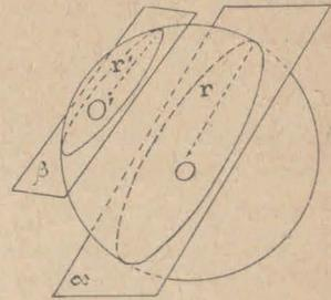
queda dividida en dos partes llamadas *hemisferios*, y en cada una de éstas hay un círculo, que puede verificarse que tienen por centro y radios a los de la esfera; razón por la cual se dice que es un *círculo máximo* de la misma.
