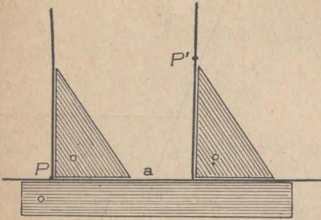
Para facilitar esta operación se puede hacer coincidir primeramente la recta con el canto de una regla como se ve en la figura.
