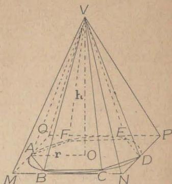
$$\text{Volumen del cono} = \frac{1}{3} \text{ Superficie de la base} \times \text{altura} = \frac{1}{3} \pi r^2 h \quad \text{o sea:}$$
