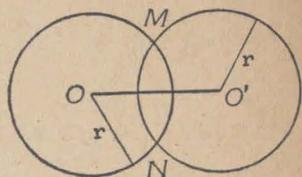
**División de un segmento en dos partes iguales con regla y compás. —**
