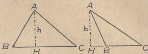
EJEMPLO:  $\overline{AH}$  es la altura del  $\triangle ABC$  correspondiente al lado  $\overline{BC}$ .
