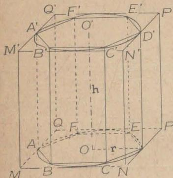
Luego, el volumen de un cilindro se podrá hallar de la misma manera que el de un prisma, o sea:
