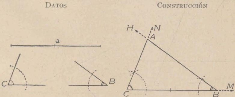
SOLUCIÓN. — Se construye un ángulo NCM igual al C, sobre uno de sus lados el segmento  $\overline{CB} = a$  y con vértice B y lado  $\overline{BC}$  un ángulo igual al B situado en el mismo semiplano que contiene al ángulo C. Los otros lados de estos ángulos se cortan en un punto A y forman el triángulo ABC pedido.
