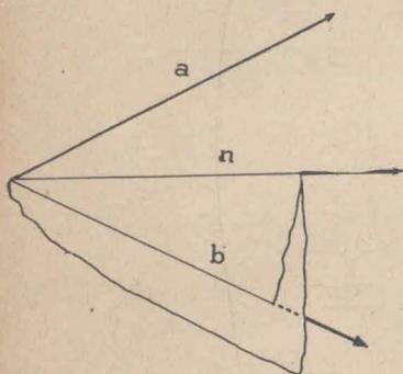
un papel transparente el ángulo dado, lo doblamos en forma tal que los lados coincidan y entonces el doblez  $n$  señala la semirrecta que divide al ángulo en dos ángulos iguales. Transportando el papel así doblado de manera que los lados coincidentes del ángulo calcado coincidan con el  $b$  y el lado  $n$  sea interior al ángulo  $ab$ , la semirrecta  $n$  lo divide en dos partes iguales.
