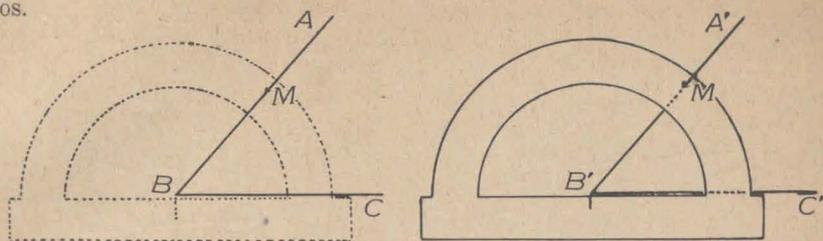
CON REGLA Y COMPÁS: Con centro en el vértice B y con un radio cualquiera se traza una circunferencia que corta a los lados en los puntos M y N. Con cen-
