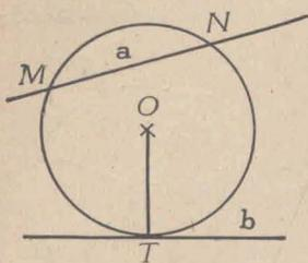
EJEMPLO: *a* es secante a la circunferencia de centro O pues tiene común con ella los puntos M y N y *b* es tangente pues solo tiene común con la circunferencia el punto T que se llama *punto de contacto*.
