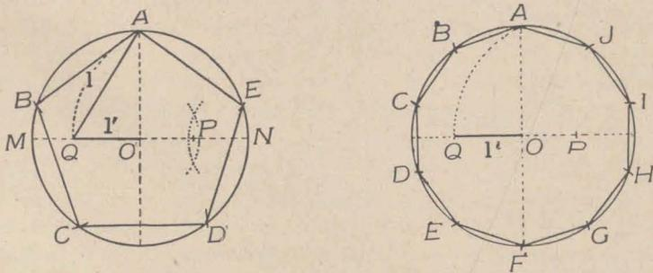
Se trazan dos diámetros perpendiculares  $AO \perp MN$ , con centro en el punto medio P del radio ON y con radio igual a PA se corta al diámetro MN en el
