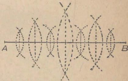
VIII) *Dividir un segmento en un número cualquiera de partes iguales.* Con LA REGLA GRADUADA. Basta medir el segmento, dividir el número así obtenido por el de partes en que se quiere dividir al segmento dado y transportar sobre éste, a partir de uno de sus extremos, segmentos consecutivos iguales al que tiene por medida el cociente anterior.
