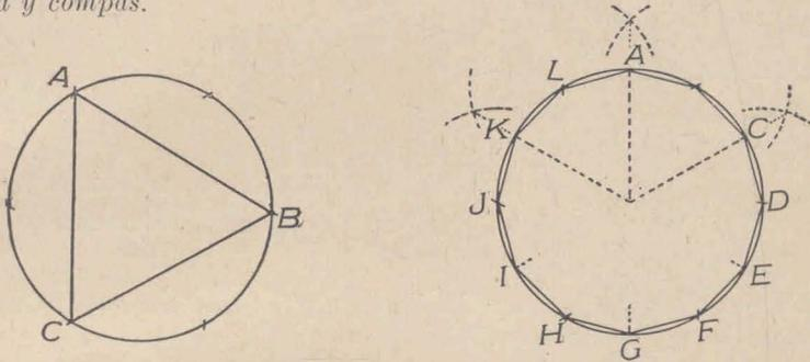
Para construir un triángulo equilátero o un dodecágono regular se procede como en el problema anterior y se unen los tres puntos de división no consecutivos en el primer caso, y para el dodecágono se trazan con regla y compás las bisectrices de los ángulos al centro del exágono, como se ve en la figura, y se unen los puntos de división consecutivos.
