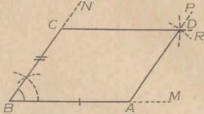
SOLUCIÓN. — Se construye el ángulo MBN igual a B; sobre uno de sus lados el segmento  $BA = a$  y sobre el otro el  $BC = b$ . Con centro C y radio  $a$  se traza una circunferencia y con centro A y radio  $b$  la cortamos en D. Uniendo este punto con A y con C se obtiene el paralelogramo pedido.
