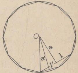
$$\text{Superficie círculo} = \frac{\text{longitud de circunferencia} \times \text{radio}}{2} = \frac{2 \pi r \times r}{2} = \pi r^2$$
