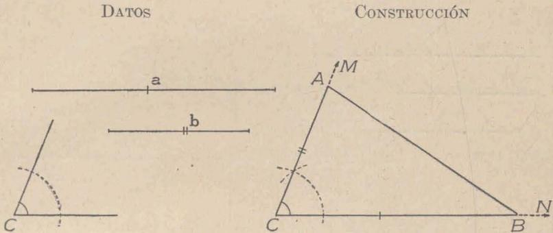
SOLUCIÓN. — Se construye el ángulo NCM igual al C y sobre uno de sus lados el segmento  $\overline{CB} = a$  y sobre el otro lado el  $\overline{CA} = b$ . Uniendo A con B se obtiene el triángulo ABC pedido.
