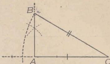
SOLUCIÓN. — Se construye el ángulo recto A, sobre uno de sus lados el segmento  $\overline{AC} = b$  y con centro en C y radio  $a$  se corta al otro lado en un punto B. Uniendo B con C se obtiene el triángulo BAC pedido.
