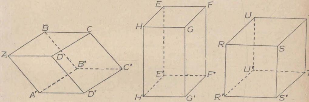
EJEMPLOS: ABCDA'B'C'D' es un paralelepípedo; EFGHE'F'G'H' es un paralelepípedo rectángulo y RSTUR'S'T'U' es un cubo.
