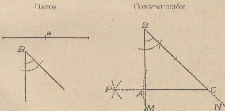
SOLUCIÓN. — Se construye el ángulo  $MBN = B$  y sobre uno de sus lados el segmento  $\overline{BC} = a$ . Trazando por C la perpendicular  $\overline{CP}$  al otro lado del ángulo B se obtiene el triángulo CBA pedido (probl. de pág. 16).
