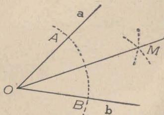
VI) *Dividir un ángulo en cuatro, ocho, etc. partes iguales.* Basta dividirlo en dos partes iguales y a cada una de ellas en otras dos y a cada una de las obtenidas en otras dos... según se trate de dividirlo en cuatro, ocho,... partes iguales, respectivamente.
