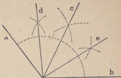
**Ángulos formados por dos rectas que se cortan.**—Al cortarse dos rectas quedan formados dos clases de ángulos.
