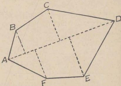
EJEMPLO: Calcular con los datos del croquis la superficie del terreno.
