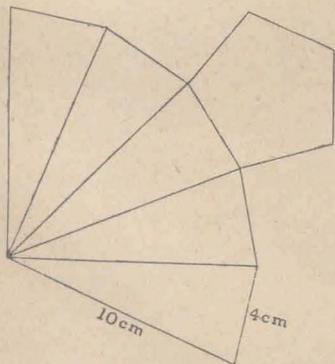
IX) *Construir una pirámide regular pentagonal de 10 cm de arista lateral y 4 cm de lado de base.* Dibújense cinco triángulos isósceles de 10 cm de lado igual y 4 cm de base y un pentágono regular de 4 cm de lado, dispuestos en la forma que indica la figura adjunta y procédase como en el caso anterior, plegando oportunamente la figura hecha de dimensiones indicadas.
