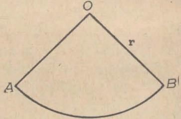
$$\text{Sup. del sector AOB} = \text{Sup. triáng. base } \widehat{AB} \text{ rectificada y radio } \overline{OA}$$
