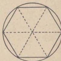
Con ese procedimiento hemos construido el triángulo equilátero, el cuadrado, el pentágono y el exágono, como se ve en la figura.
