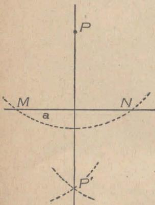
Con centro en el punto dado  $P$  se traza una circunferencia que corte a la recta  $a$  en los puntos  $M$  y  $N$ , para lo cual basta que pase por un punto del semiplano que limita  $a$  y no contiene a  $P$ . Con el mismo radio y centro en  $M$  y  $N$  se trazan dos circunferencias que se cortan en los puntos  $P$  y  $P'$  (en la figura solo se han trazado los arcos que se cortan en  $P'$ ). Trazando la recta  $PP'$  se obtiene la perpendicular pedida.
