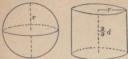
Volumen de la esfera de radio  $r =$  Volumen del cilindro de radio  $r$  y altura  $\frac{2}{3} 2r$
