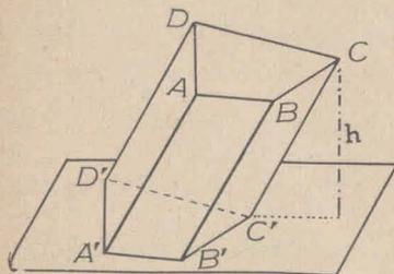
DEFINICIÓN. — Se llama *altura* de un prisma a la distancia de un punto de una de las bases al plano de la otra, o sea el segmento de la perpendicular al plano de la base comprendido entre ese punto y ese plano.
