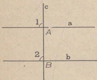
**Trazado de paralelas.** — Trazar por un punto exterior a una recta la paralela a la misma.
