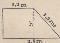
debemos calcular  $h$  para poder aplicar la fórmula. Para ello basta observar que es  $h$  un cateto del triángulo rectángulo cuya hipotenusa es el lado oblicuo de 1,5 m y el otro cateto es igual a la diferencia entre las bases  $2,10 \text{ m} - 1,20 \text{ m} = 0,90 \text{ m}$ . Luego aplicando el corolario del Teorema de Pitágoras da:
