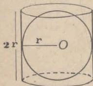
*Superficie esfera radio  $r = \text{Sup. lat. cilin. radio } r \text{ y alt. } 2r.$*
