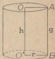
**Fórmula de la superficie lateral y total del cilindro.** — Consideremos un cilindro material, de madera por ejemplo, y apliquemos sobre su superficie
