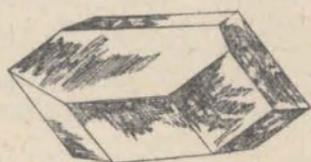
Fig. 142. — Cristal de sulfato cúprico.
