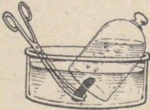
Fig. 104. — Descomposición del agua por el carbón al rojo.
