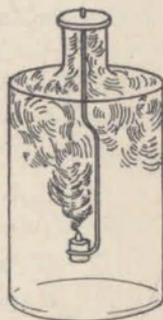
Fig. 69. — Combustión del Cl en el seno del  $O$ .
