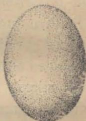
Fig. 2. — Elipsoide producido por el fuerte calentamiento de la esfera de calcita.
