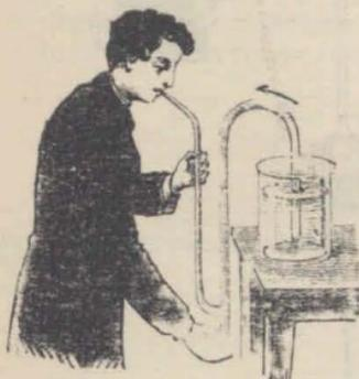
Fig. 83. — Carga del sifón.
