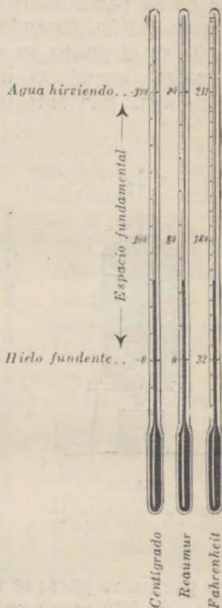
Fig. 99. Escalas termométricas.
