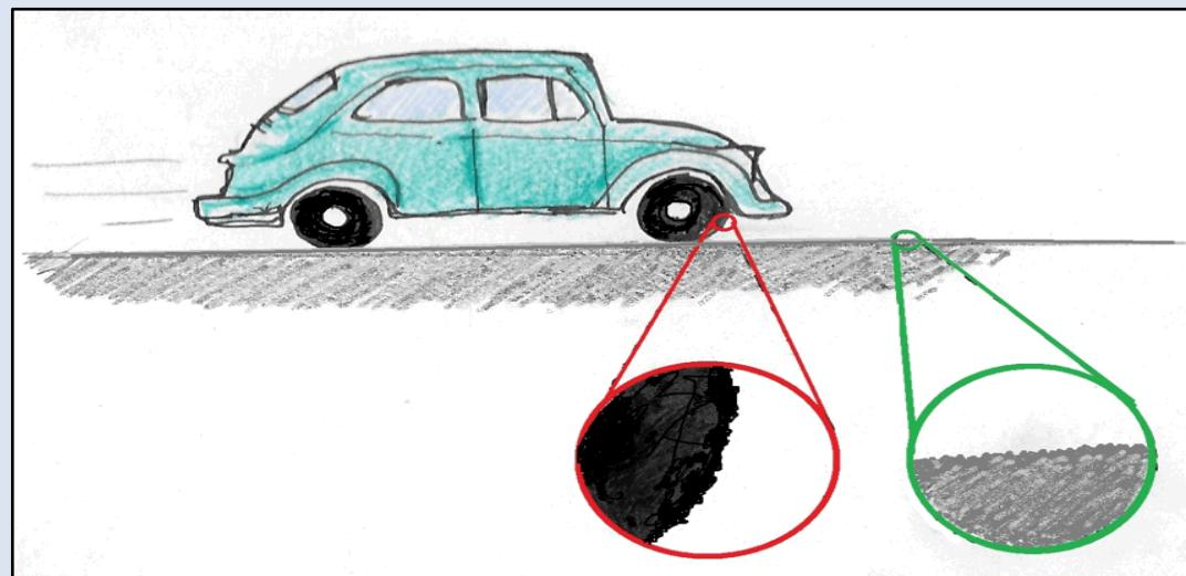
**Una lupa poderosa permite detectar que las superficies en contacto tienen imperfecciones. Estas imperfecciones se enganchan entre sí y trapan el desplazamiento de los objetos**
