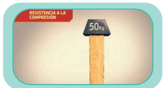
En el sentido longitudinal de la fibra la resistencia a la compresión es 5 a 8 veces mayor que transversalmente.
