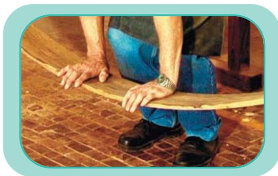
**e.** Para la valoración de una madera como material, la **resistencia** es una de las propiedades importantes. Se entiende por tal la que ofrece la madera frente a la actuación de fuerzas externas. Se distinguen entre resistencia a la tracción, la compresión la flexión deslizamiento, cortadura, torsión, pandeo y escisión (rajado en el sentido de la fibra).
