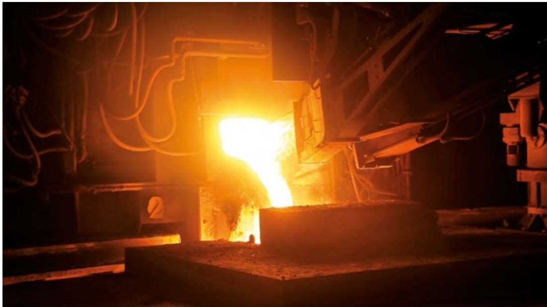
Volcado de acero fundido desde la boca del horno.
