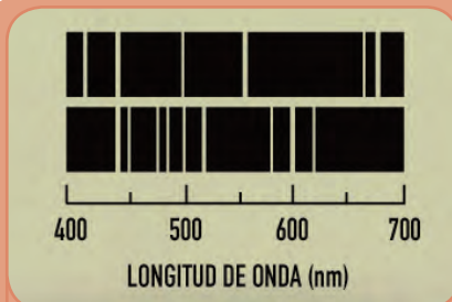
Figura 14. Ejemplos de espectros de luz visible emitida por gases de sodio (Na) y de mercurio (Hg)
