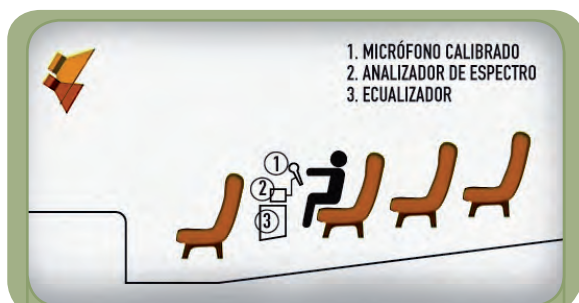
Figura 17. Para analizar el comportamiento acústico de una sala deben realizarse mediciones utilizando equipamiento adecuado
