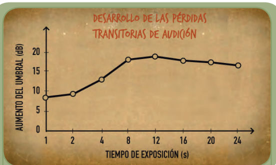
Figura 28. Pérdidas transitorias de audición provocadas por la exposición a una banda de ruido de una octava centrada en 4 KHz y con un nivel de presión sonora de 85 dB
