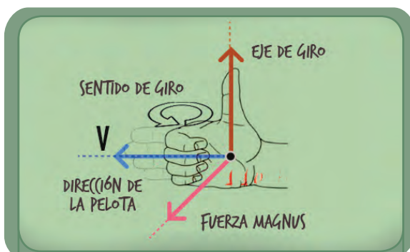
Figura 15. Regla de la mano derecha para determinar la dirección de la fuerza Magnus
