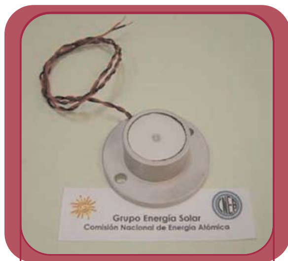
Radiómetro elaborado en CNEA con sensor fotovoltaico.
