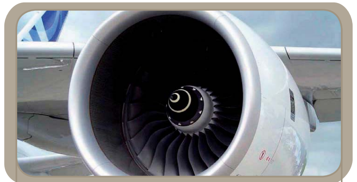
Figura 30. Las turbinas del Airbus A380 usan alrededor de 11 toneladas de titanio
