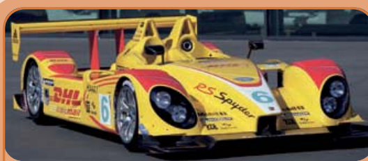
Imagen 54. Carrocería de automóvil de competición fabricada con fibra aramídica Kevlar
