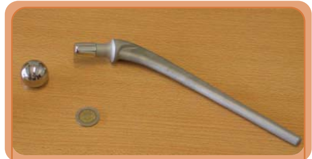
Imagen 6. Componentes metálicos de un implante total de cadera fabricados en aleación titanio-aluminio-vanadio
