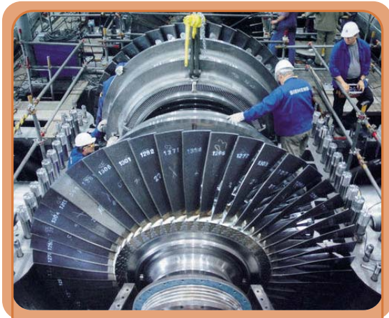
Imagen 1. Turbina de aleación níquel-cromo para un generador de electricidad
