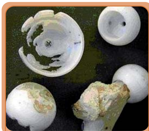
Imagen 49. Cabezas de fémur fabricadas en PTFE y daño producido en algunas de ellas
