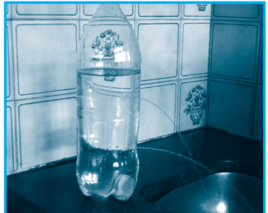
Una botella con perforaciones a distintas alturas; de acuerdo con la ecuación de Torricelli, la velocidad de salida del agua depende de la altura del líquido por encima de cada orificio, lo que puede verse por la mayor distancia a la que llega el chorro inferior.
