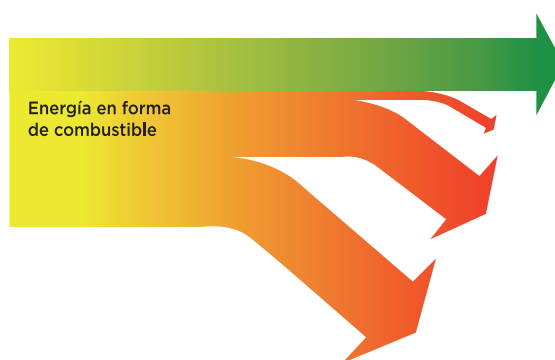
Diagrama de Sankey representante del flujo de energía en una central eléctrica típica
