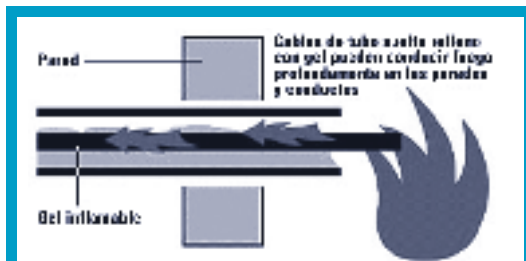
Propagación del fuego en cables de fibras ópticas con gel
