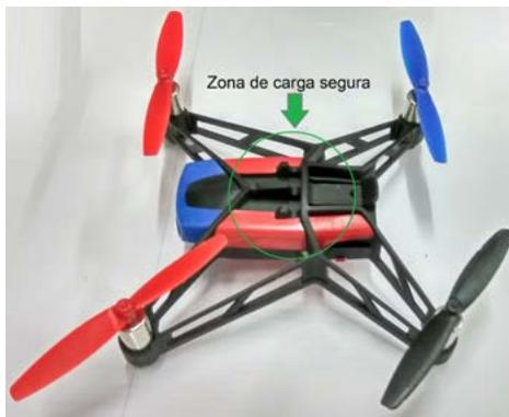
Comenzamos con un sobrecito y verificamos que lo levanta. Luego, seguiremos agregando sobrecitos a nuestro dron hasta que ya no pueda realizar su entrega. Podemos ayudarnos con algo de hilo o una bandita elástica en la zona segura del dron para afirmar la carga. Al final, retiramos los sobrecitos, los contamos, calculamos el peso de nuestra carga y completamos la siguiente tabla:
