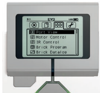
Pantalla de aplicaciones instaladas y creación de programas: Esta pantalla es de suma utilidad ya que permite realizar directamente, sobre el bloque inteligente EV3, programas de baja complejidad, sin tener que usar el software en la computadora.
