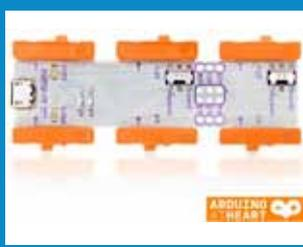
El **módulo de Arduino** es una minúscula computadora. Agrega el poder de programación a los circuitos SuperBot Electro, permite crear secuencias complejas de acciones y explorar nuevos niveles de lógica.
