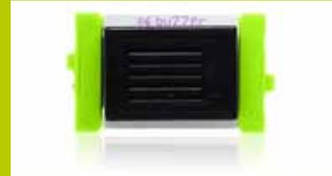
**Zumbador:** Emite sonidos, sube y baja el volumen en función de la tensión en la entrada del módulo.
