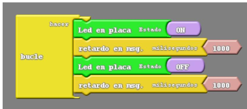
Analicemos el primer programa. Los comandos que se ponen dentro de la estructura bucle se repetirán una y otra vez mientras el ladrillo tenga energía. Es habitual que toda programación de un robot tenga este bucle infinito. El primer comando “Led en placa” nos permite determinar el estado del led que está en el ladrillo (es un led testigo, que será de mucha utilidad para testear cosas). Cuando se pone en *ON*, se enciende, mientras que en *OFF* queda apagado.
