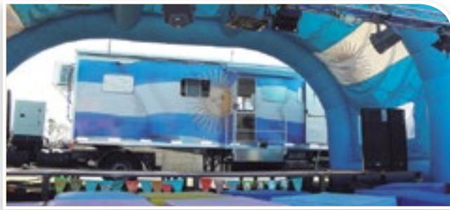
Está realizado sobre una estructura tubular que permite un fácil montaje y desmontaje con uniones móviles y sujeciones mediante abrazaderas ajustables.
