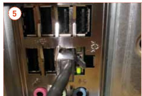
**5.** Conexión del cable de red en la placa del servidor (placa superior, junto a los puertos USB).
