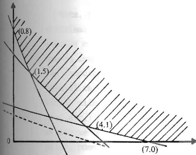
En el caso de un problema como el anterior, de dimensión 2 (o sea, de dos incógnitas) es posible hallar el resultado gráficamente. En efecto, la función lineal  $F$  toma valores constantes sobre cada recta de ecuación  $25x + 50y = k$  (en la figura se ha dibujado de puntos la recta para  $k = 100$ ), con valores de  $k$  crecientes cuando la recta se traslada paralelamente alejándose del origen. Moviendo la recta de tal modo, el primer vértice encontrado es el  $(4, 1)$  que da la solución.
