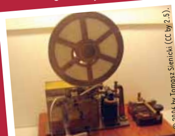
Telégrafo utilizado para transmisiones en código morse.
