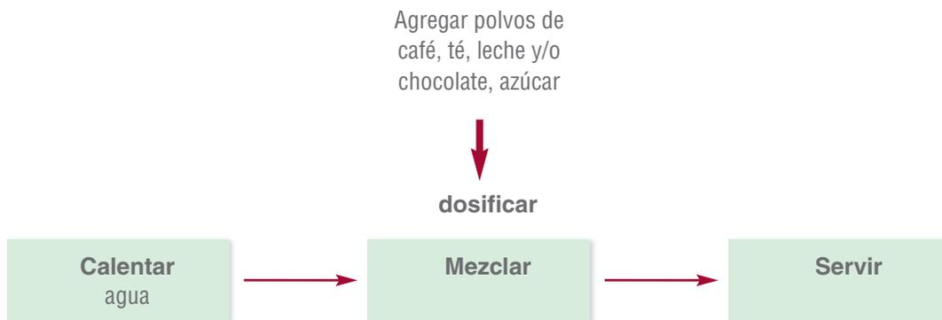
El docente puede reflexionar con los alumnos acerca de las similitudes que existirán entre los pasos del proceso listado y las diferencias respecto a cómo se realizan en la máquina controlada por un programa. Los materiales que circulan por el sistema se deben *calentar, dosificar, mezclar y servir*.
