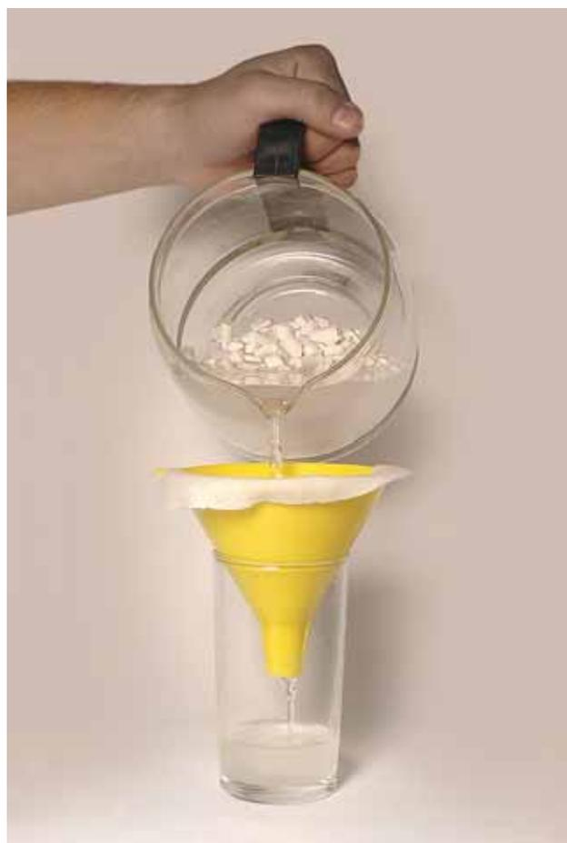
Tanto la **decantación** como la **filtración** son métodos mecánicos que permiten separar una fase sólida de una líquida.
