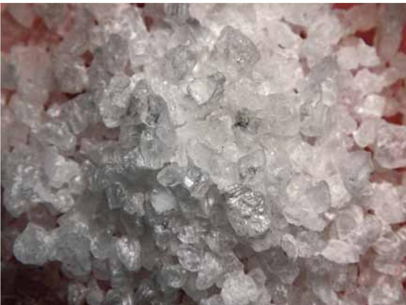
El cloruro de sodio disuelto en agua puede ser separado evaporando lentamente el agua, para dar tiempo a la formación de cristales. Ya mencionamos antes que este proceso se llama cristalización.
