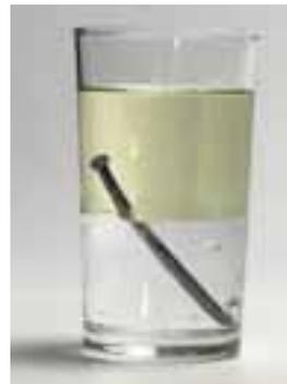
Las diferentes actividades que ha realizado le permiten determinar las principales causas de la corrosión del hierro. Este problema necesita ser solucionado, es decir, la superficie del hierro no puede estar expuesta al aire húmedo, para evitar su oxidación. Nuevamente, la Química aporta soluciones a un problema que nos afecta continuamente.
