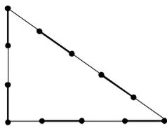
Los funcionarios reales y los constructores utilizaban una "escuadra" construida con una cuerda de trece nudos, ubicados a una misma distancia. Así determinaban ángulos rectos para delimitar terrenos o para ubicar construcciones orientadas según los puntos cardinales, como las pirámides.
