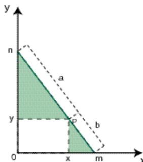
La relación existente entre los lados homólogos de los triángulos semejantes sombreados permite determinar que se trata de una elipse ( $\sqrt{b^2 - y^2} / b = x/a \Rightarrow x^2 / a^2 + y^2 / b^2 = 1$ ).
